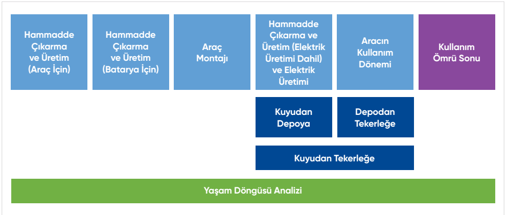
Şekil 2.13. Araçlar için LCA Aşamalarına Şematik Bakış
