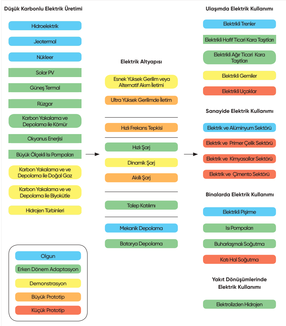
Şekil 3.37. Elektrik Sektöründe Teknoloji Hazırlık Seviyeleri (TRL )
